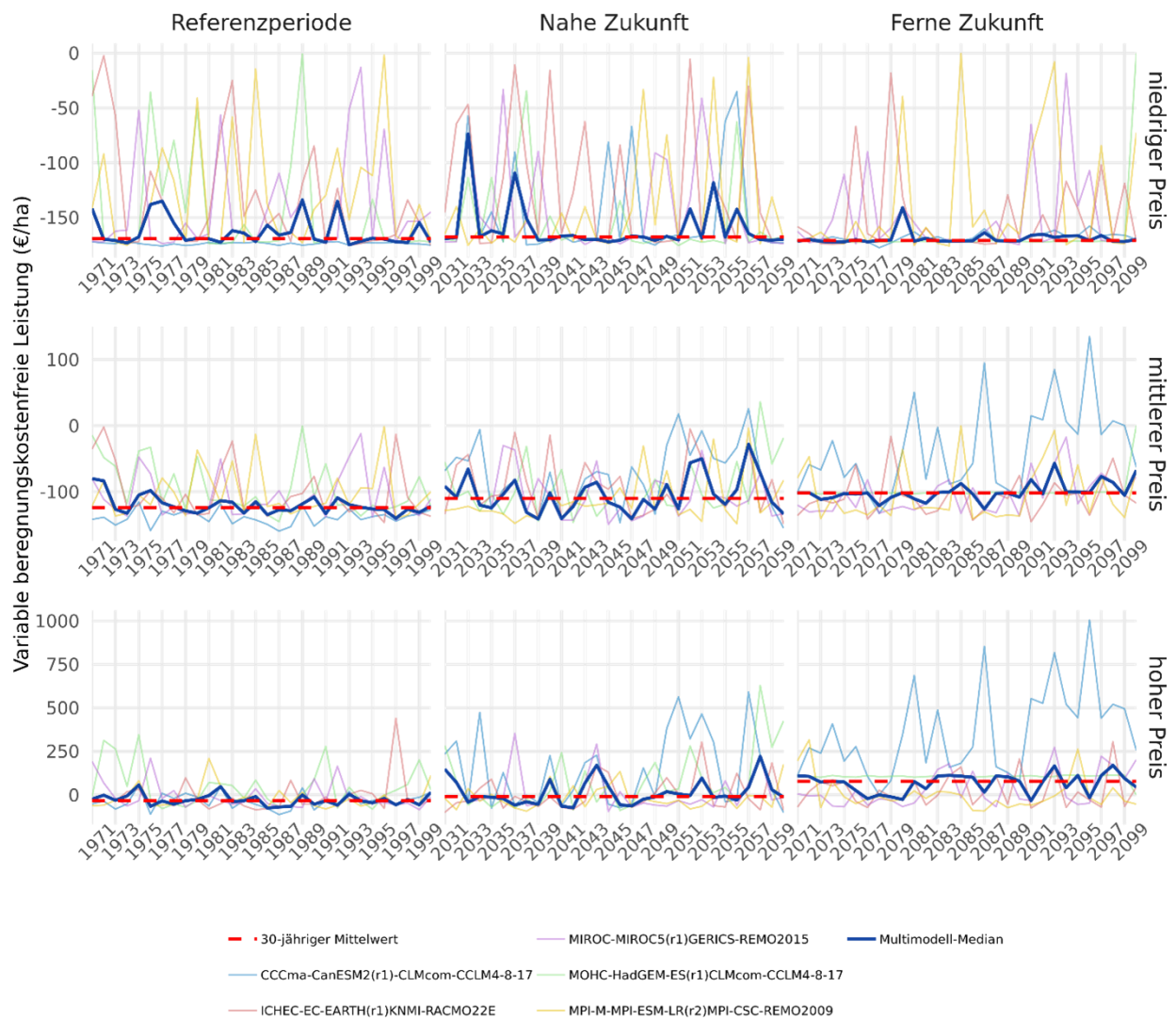
Abbildung 80: Ex-ante-Bewässerungswürdigkeit von Winterweizen unter variablen Kosten bei der Bewässerung durch eine mobile Beregnungsmaschine mit Starkregner und Grundwasser
