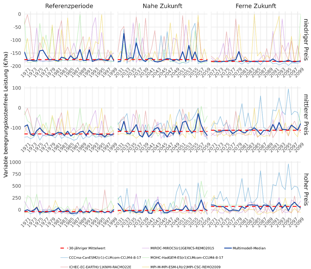
Abbildung 81: Ex-ante-Bewässerungswürdigkeit von Winterweizen unter variablen Kosten bei der Bewässerung durch eine mobile Beregnungsmaschine mit Düsenwagen und Grundwasser
